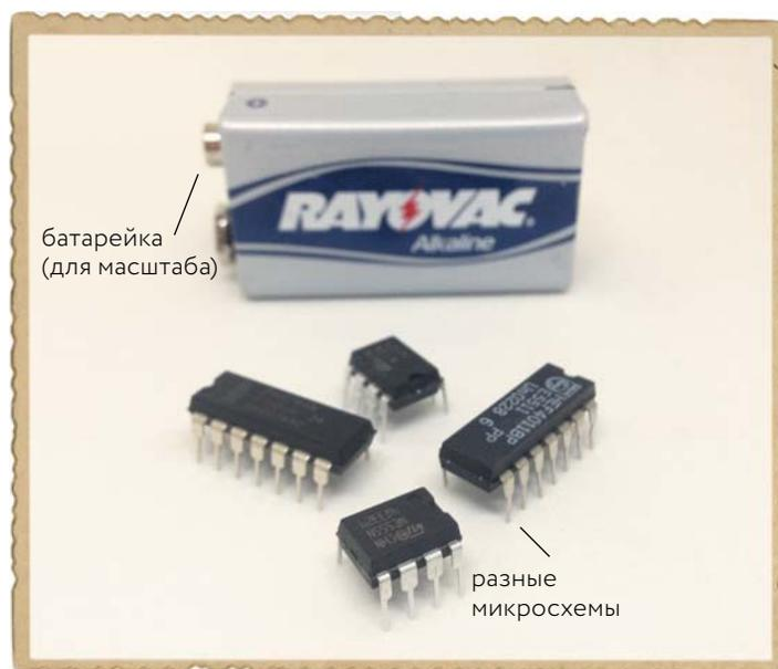
Внутри интегральных схем могут находиться схемы музыкального проигрывателя, радиоприемника, блока дистанционного управления и что-нибудь совершенно иное. Поскольку одна ИС может содержать очень сложную схему, на основе микросхем можно создавать схемы самого разного назначения, не собирая все их элементы с нуля.
