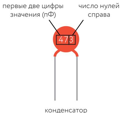
В этом примере конденсатор имеет код 473. Первые две цифры дают 47, а третья — число нулей справа. Добавляем эти нули и получаем 47 000 пФ, или 47 нФ, или 0,047 мкФ.
