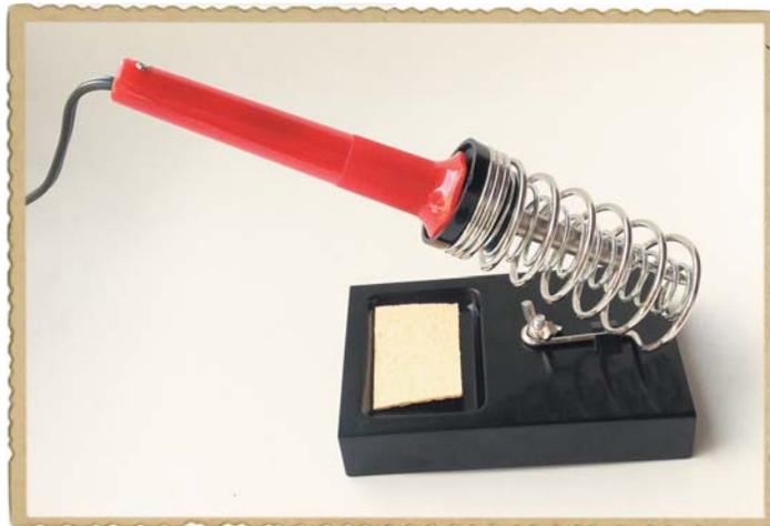
Минуты через две попробуйте, достаточно ли нагрелся паяльник, прикоснувшись его жалом к припою. Если припой начнет плавиться, паяльник готов к работе.
