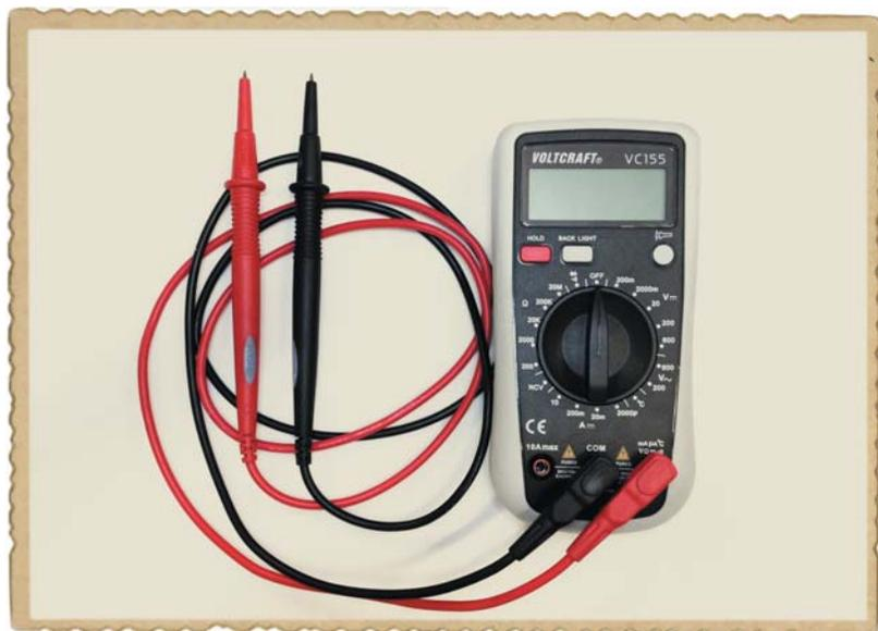
Красный провод мультиметра — положительный, а черный — отрицательный. Большой поворотный переключатель в центре позволяет задавать вид и предел измерений измеряемой величины. Если при создании цепи у вас возникнут трудности, измерение напряжений в ее ключевых точках — верный способ понять, в чем дело.
