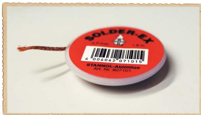
Если прижать к месту пайки оплетку для выпайки и нагреть паяльником, припой расплавится и оплетка впитает его, как сухая тряпка впитывает воду. Если теперь убрать оплетку, припой останется на ней, а не на плате.
