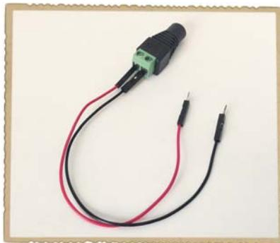
иметь маркировку «+» и «-». Слегка отверните винты зажимов клеммника, вставьте в оба зажима концы проводов и затяните винты. Если в качестве положительного провода вы используете провод в красной изоляции, а в качестве отрицательного — в черной, вам будет проще правильно подключиться к плате.
