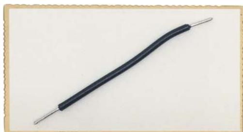
Отрежьте провод длиной около 5 см и зачистите его концы на участках длиной около 8 мм. Удаление изоляции с коротких отрезков провода может быть непростым делом, и, если у вас возникнут трудности, возьмите кусок подлиннее. Когда вы поймете, с отрезка какой длины вам легче всего удалять изоляцию, подготовьте еще два таких отрезка. Припаяйте эти провода в качестве перемычек для завершения оставшихся соединений.
