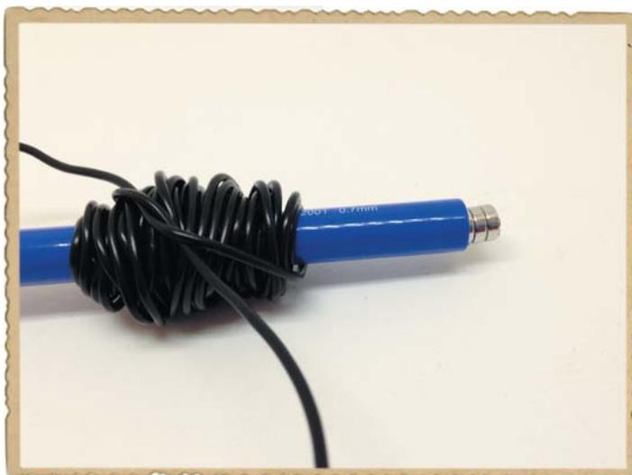
Возьмите трубку с катушкой и щупы мультиметра в руку, зажав отверстия на концах трубки пальцами, чтобы магниты не выпали из нее, и трясите ее вдоль по направлению ее оси!
