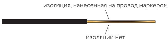
Положите катушку ротора на стол и нанесите нестираемым маркером линию вдоль одного из проводов на одной стороне, чтобы сделать ее не проводящей ток. Эта линия должна быть расположена так, чтобы ротор отключался от батарейки в момент, когда его катушка находится над магнитом в горизонтальном положении.
