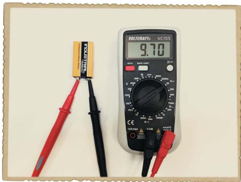
В приведенном примере мультиметр измеряет напряжение между положительным и отрицательным выводами батарейки 9 В. Обратите внимание, что переключатель установлен на 20 V в секторе, отмеченном прямой линией. Но есть и другой сектор V, отмеченный волнистой линией. Посмотрим, что обозначают эти символы.
