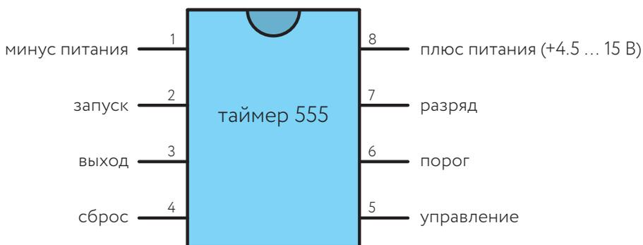
У таймера 555 восемь выводов, пронумерованных в направлении против часовой стрелки, начиная с левой верхней (верх обозначается полукруглой выемкой или углублением в виде точки, или и тем и другим сразу). Назначение выводов указано в техническом описании, но роли двух выводов настолько важны, что нужно сказать о них прямо сейчас.
