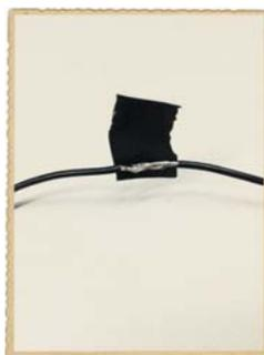
После этого тем же способом соедините красный провод разъема для подключения батарейки с красным проводом зуммера.
