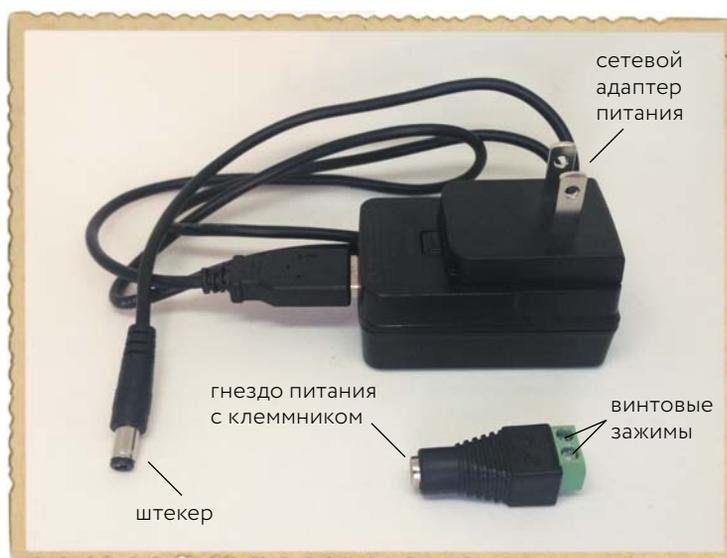
Для питания или подзарядки многих электронных устройств используются сетевые адаптеры, включаемые в сетевую розетку и подключаемые к питаемому устройству штекером. Существуют сетевые адаптеры с разным напряжением питания на выходе; нам нужен адаптер на 5 В постоянного тока.
