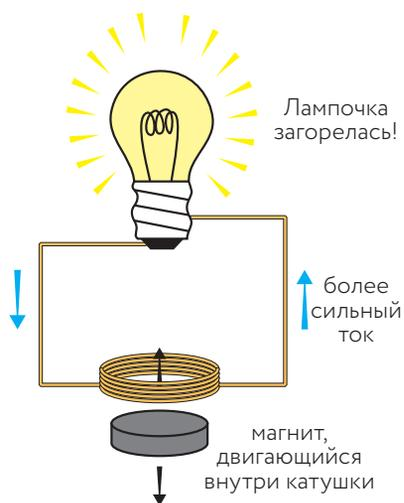
возле провода) в электричество. Чтобы с помощью магнита и провода получить большую мощность, можно свернуть провод в катушку. Она станет действовать, как группа проводов, и, когда внутри нее начнет двигаться магнит, мощности, создаваемые током в каждом витке, будут суммироваться, так что в итоге мощность окажется намного больше той, которая создается в прямом проводе.
